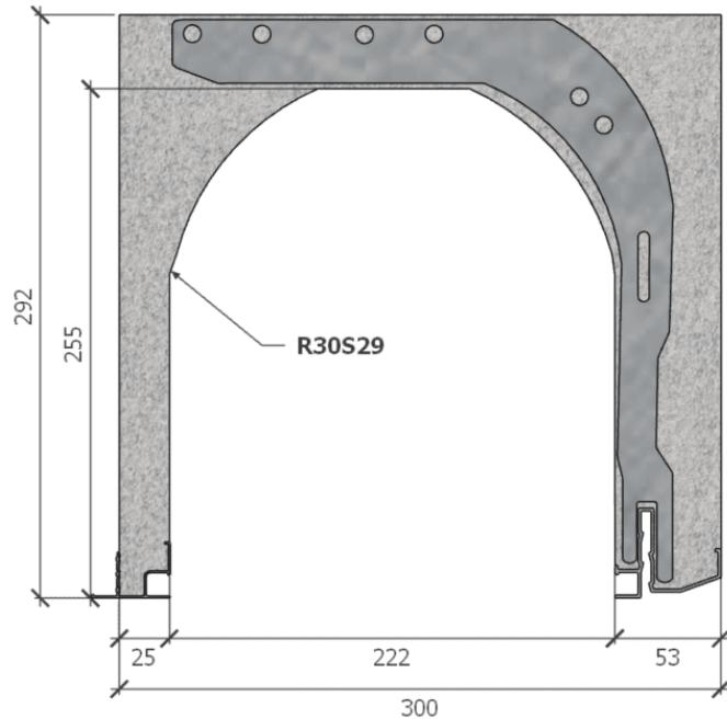
**Option équerres et ligatures [PDF]** : conformément à l'avis technique du CSTB, les coffres renforcés seront ligaturés au chaînage et fixés à la traverse haute au moyen d'équerres. Equerres et ligatures sont livrables séparément ou intégrées dans le coffre à la production.
