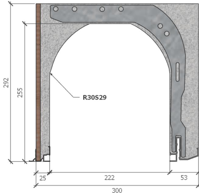
**Option équerres et ligatures [PDF]** : conformément à l'avis technique du CSTB, les coffres renforcés seront ligaturés au chainage et fixés à la traverse haute au moyen d'équerres. Equerres et ligatures sont livrables séparément ou intégrées dans le coffre à la production.
