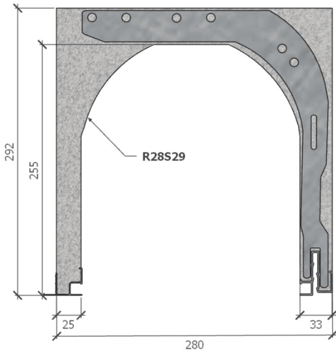
**Option équerres et ligatures [PDF]** : conformément à l'avis technique du CSTB, les coffres renforcés seront ligaturés au chaînage et fixés à la traverse haute au moyen d'équerres. Equerres et ligatures sont livrables séparément ou intégrées dans le coffre à la production.
