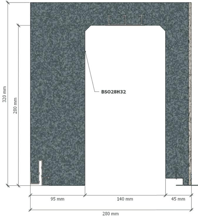
**Option cornière [PDF]** : les rails 28FR permettent l'ajout d'une cornière d'étanchéité et de fixation avec la menuiserie. Ces cornières crantées de 40x30 mm sont livrables en paquet de 100 pièces ou insérées dans le coffre.
