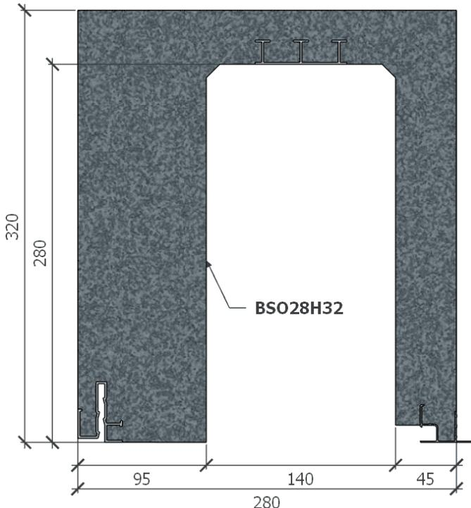
**Option cornière [PDF]** : les rails 28FR permettent l'ajout du cornière d'étanchéité et de fixation avec la menuiserie. Ces cornières crantées de 40x30 mm sont livrables en paquet de 100 pièces ou insérées dans le coffre.
