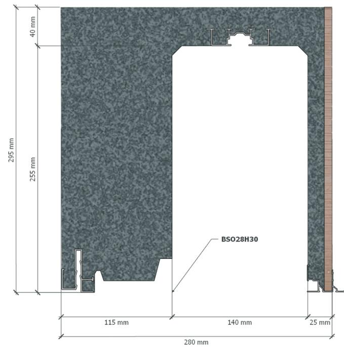
**Option cornière [PDF]** : les rails 28FR permettent l'ajout d'une cornière d'étanchéité et de fixation avec la menuiserie. Ces cornières crantées de 40x30 mm sont livrables en paquet de 100 pièces ou insérées dans le coffre.
