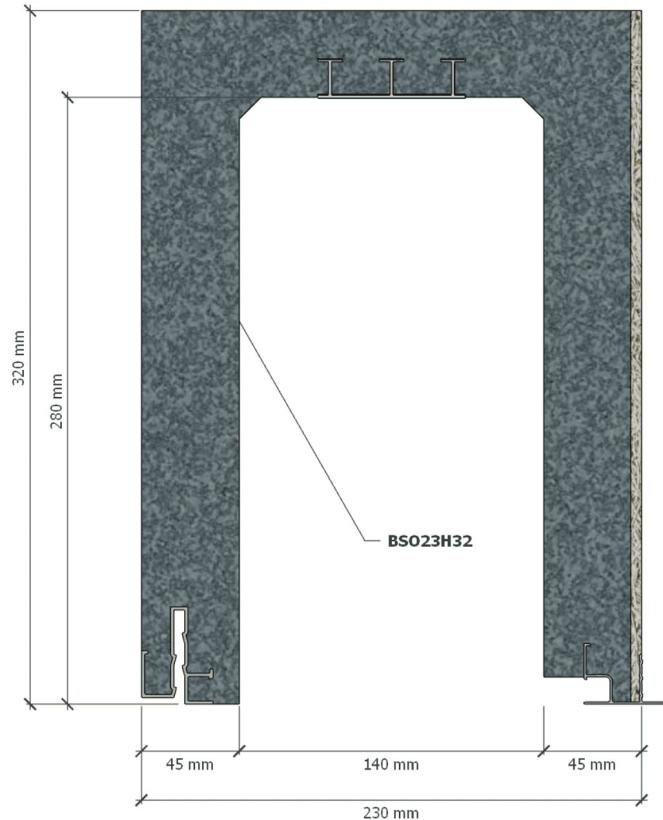
**Option cornière [PDF]** : les rails 28FR permettent l'ajout d'une cornière d'étanchéité et de fixation avec la menuiserie. Ces cornières crantées de 40x30 mm sont livrables en paquet de 100 pièces ou insérées dans le coffre.
