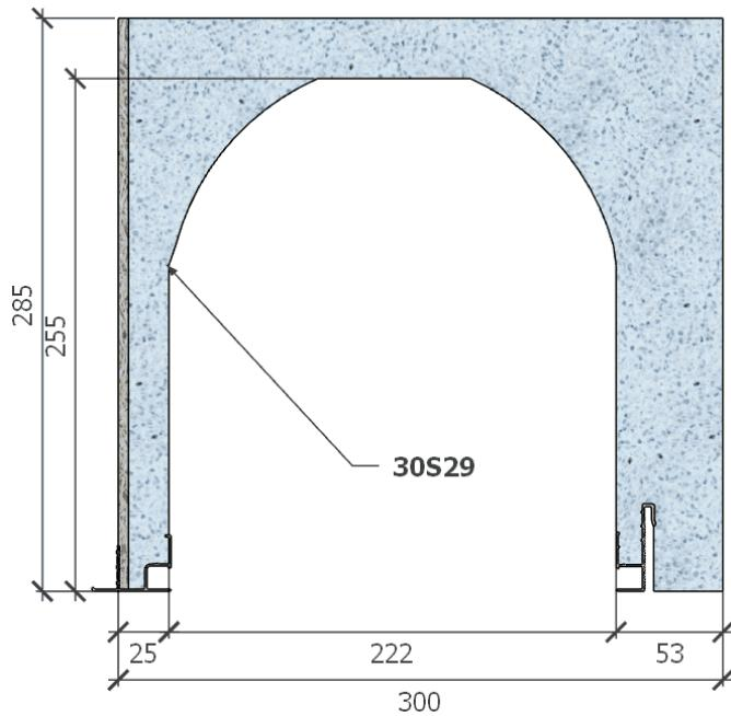
**Option cornière [PDF]** : les rails 8E permettent l'ajout du cornière d'étanchéité et de fixation avec la menuiserie. Ces cornières crantées de 40x30 mm sont livrables en paquet de 100 pièces ou insérées dans le coffre.
